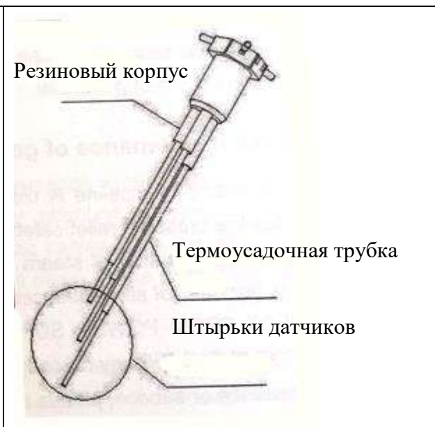
Рисунок 6 Схема датчика уровня воды
