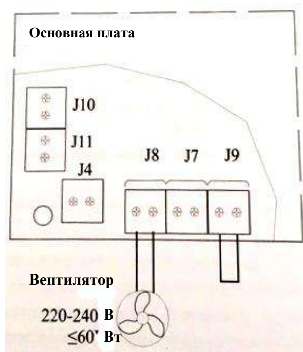
Рисунок 19 Схема подключения вентилятора
