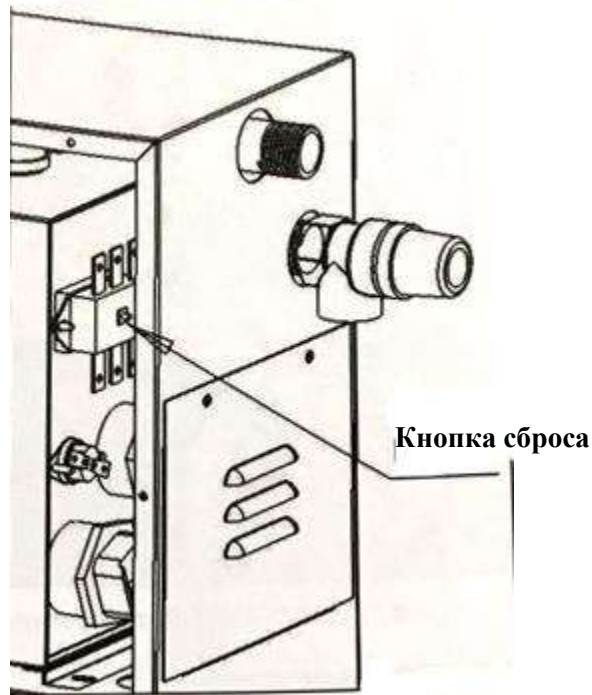
Рисунок 18 Ручной сброс регулятора температуры
