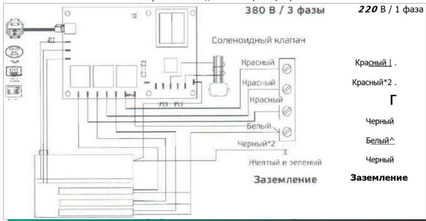
Рисунок 1. Схема подключения парогенератора
