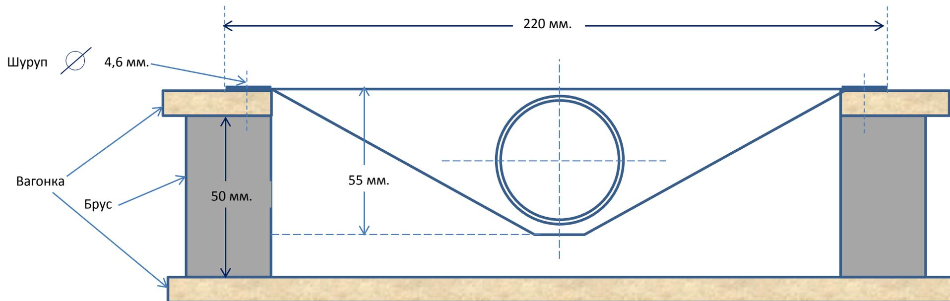
Рис. Врезка тылового нагревателя (вид сверху).
