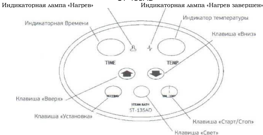
Рисунок 3. Указания по установке контроллера температуры ST-135AD
